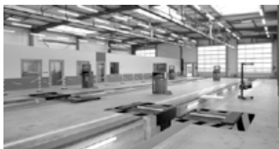
Banc d'essais de véhicules poids lourds.
